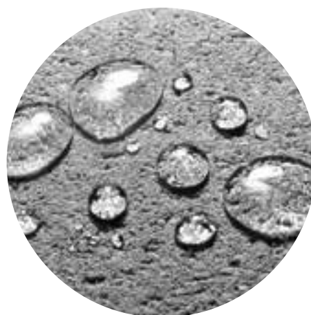
Effet perlant sur béton protégé avec ProtectGuard® Color
